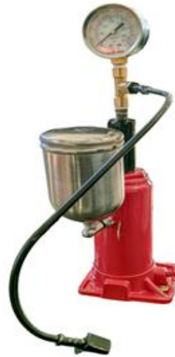
Gambar 3. Bentuk fisik dari alat uji nozzle injector yang telah selesai dirakit.
