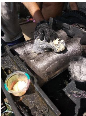
Gambar 1. Pembuatan kompon karet dengan rolled mill
