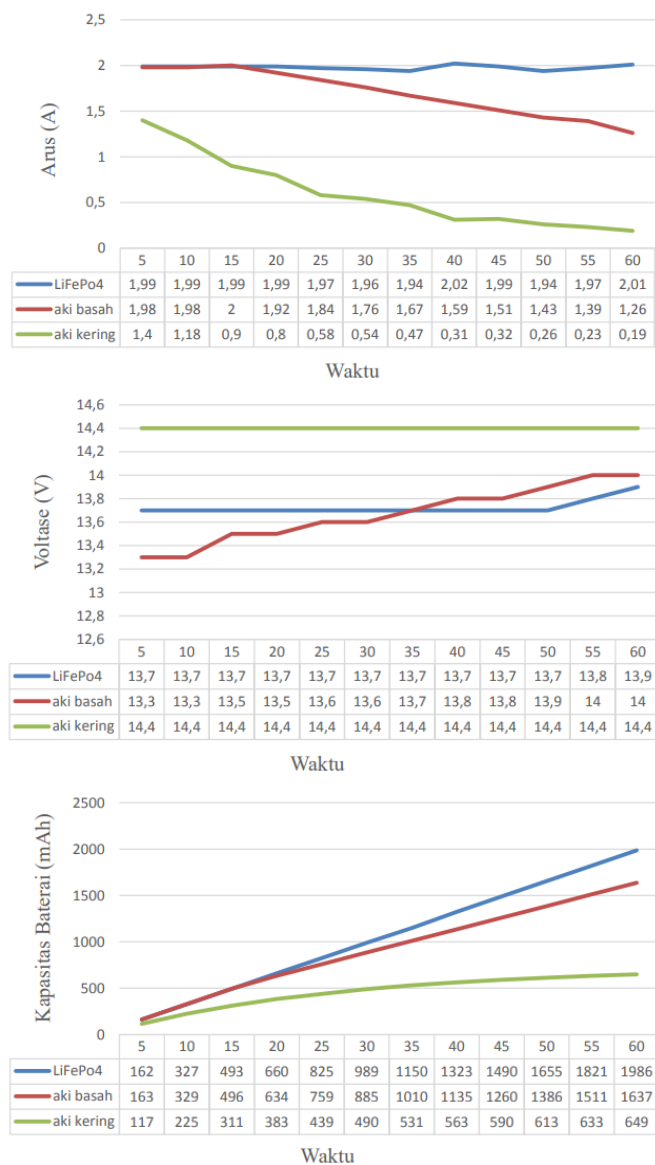
Gambar 4. Grafik pengisian parameter arus, tegangan dan kapasitas terhadap waktu
