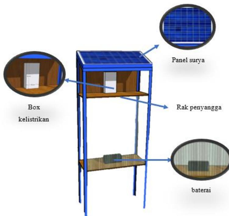
Gambar 2. Desain prototipe PLTS
