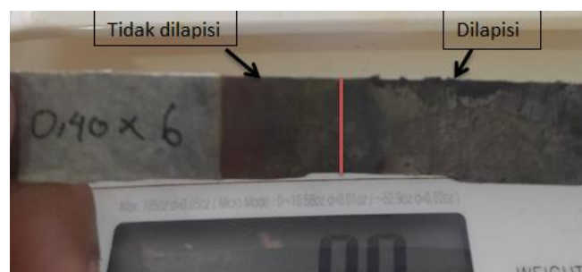
Gambar 3 Hasil Elektroplating Kawat Diameter 0,40 mm dengan 6 lilit
