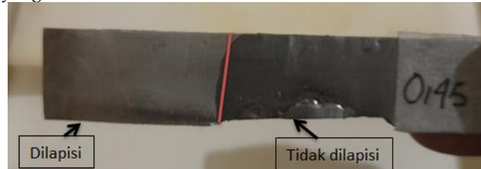
Gambar 5 Hasil Elektroplating Kawat Berdiameter 0,45 mm dengan 4 lilit
