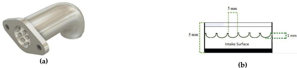
**Gambar 3.** Desain (a) Dimple intake manifold lubang rapat (b) Spesifikasi lubang dan jarak antar lubang
