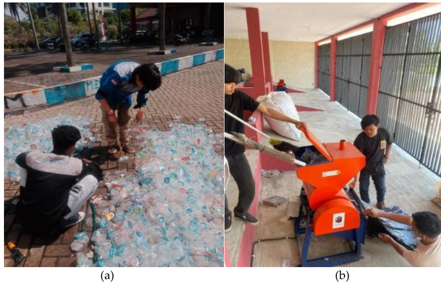
Gambar 3. Proses persiapan sampah plastik PP untuk dijadikan bahan bakar; (a) Pembersihan dan pengeringan; (b) Proses penggilingan
